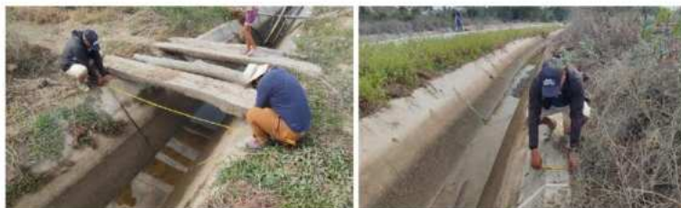
Foto: Medición de dimensionamiento Geométrico Canal La Conquista
