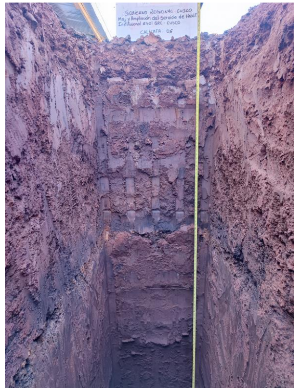
Foto 22: Perfil Estratigráfico Calicata C-06.
