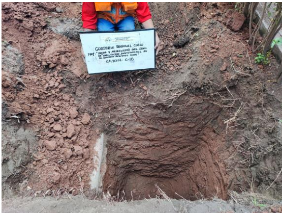
Foto 55: Perfil Estratigráfico Calicata C-16.
