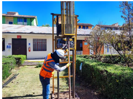
Foto 68: Ensayo SPT Sondeo S-1.
