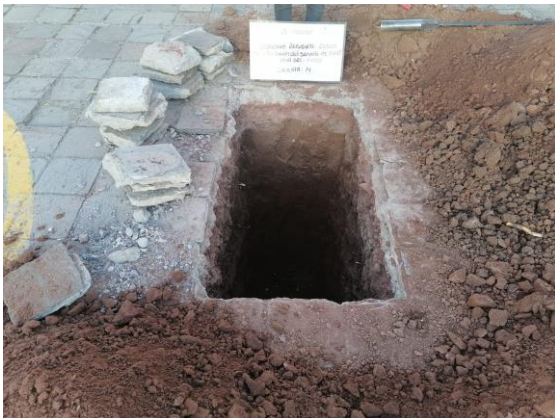
Foto 49: Perfil Estratigráfico Calicata C-14.
