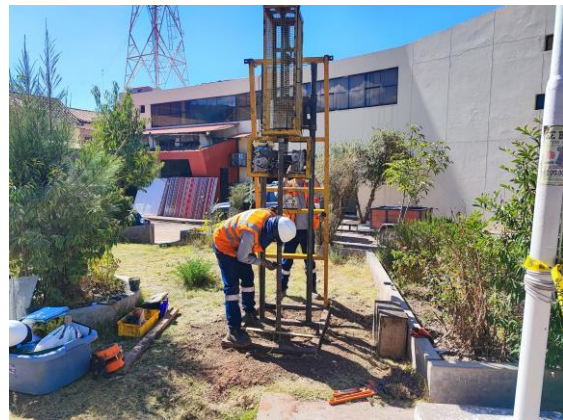
Foto 88: Ensayo SPT Sondeo S-5.
