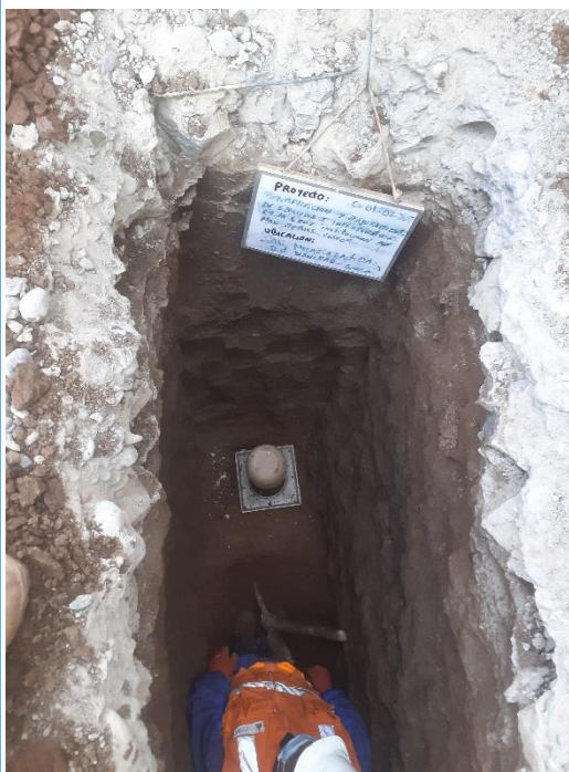
FOTO N°6.- Ensayo densidad de Campo C-01
