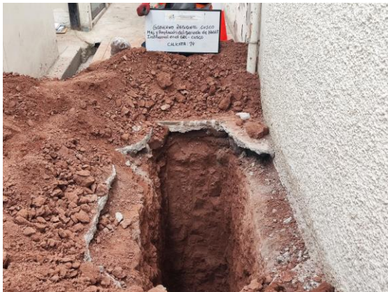
Foto 43: Perfil Estratigráfico Calicata C-12.
