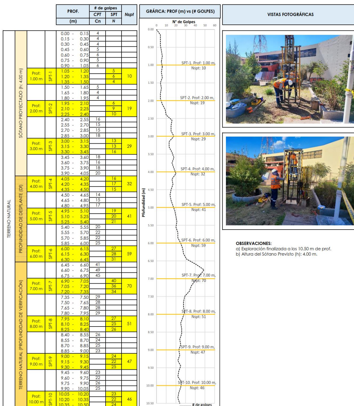
Imagen 72: Valores de resistencia a la penetración por número de golpes en el sondeo S-5.
