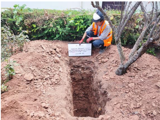
Foto 31: Perfil Estratigráfico Calicata C-08.
