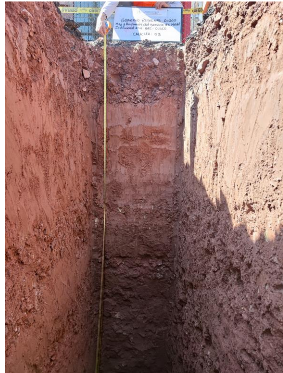
Foto 10: Perfil Estratigráfico Calicata C-03.
