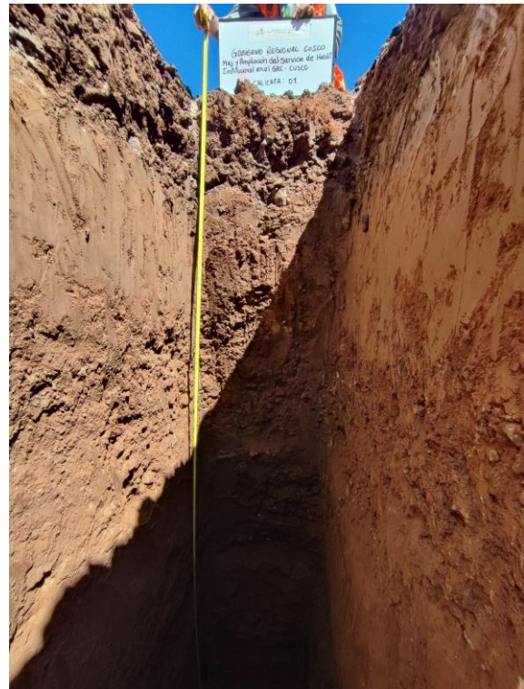
Foto 2: Perfil Estratigráfico Calicata C-01.
