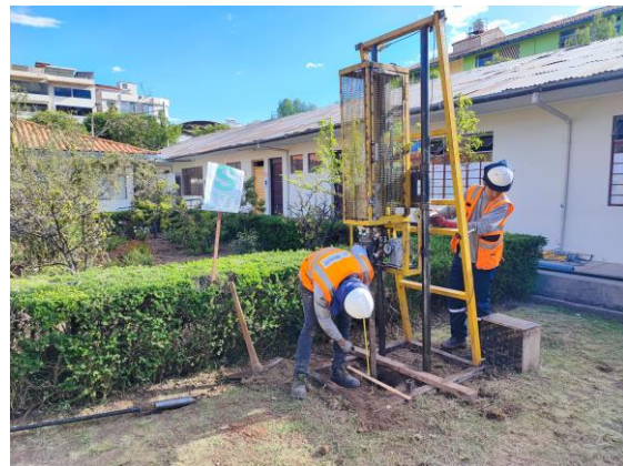
Foto 73: Ensayo SPT Sondeo S-2.
