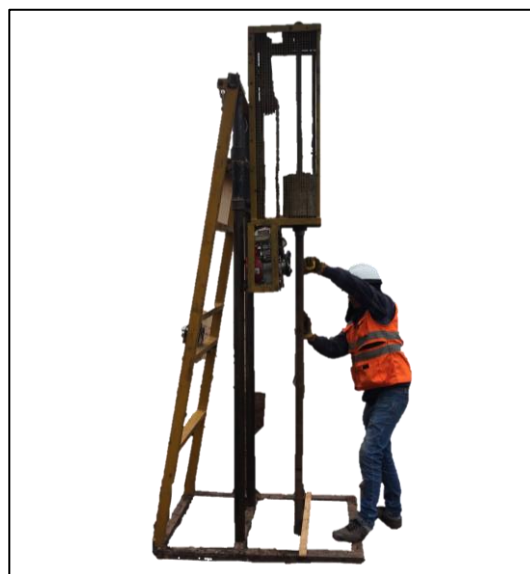
Foto 1: Equipo SPT GEOMAX SOLUTIONS INGENIEROS.
