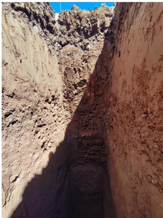
Foto 2: Arcilla de plasticidad baja con presencia de niveles no continuos de Grava limosa-arcillosa con arena como parte de la Formación San Sebastián.
