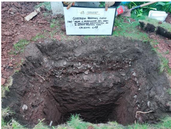
Foto 61: Perfil Estratigráfico Calicata C-18.
