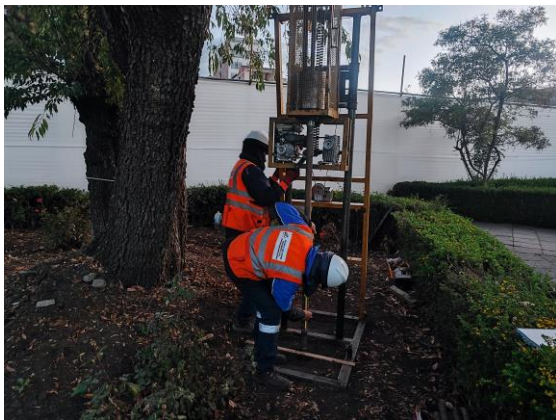
Foto 77: Ensayo SPT Sondeo S-3.
