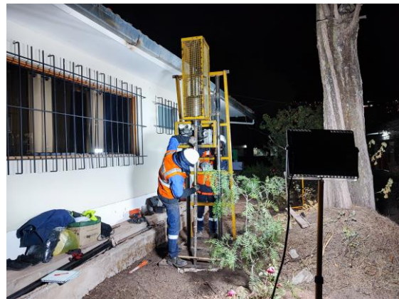
Foto 83: Ensayo SPT Sondeo S-4.
