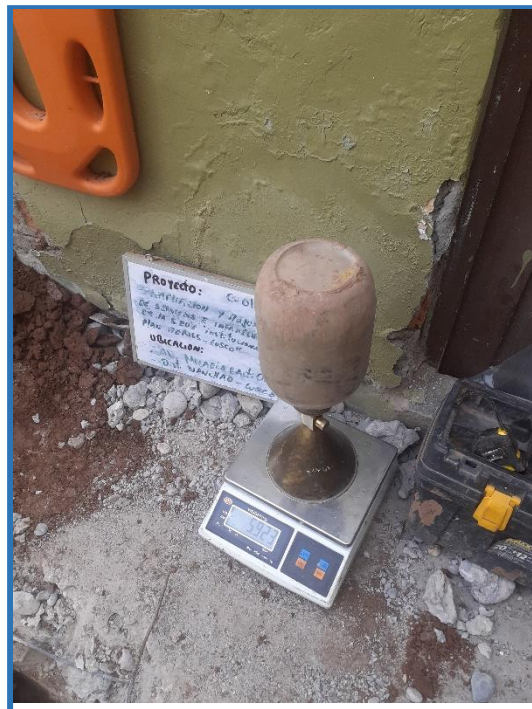
FOTO N°7.- Ensayo densidad de Campo C-01
