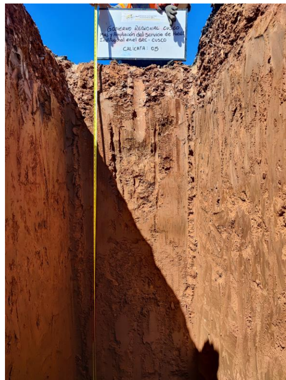
Foto 18: Perfil Estratigráfico Calicata C-05.
