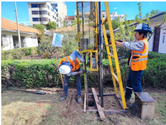
Foto 72: Ensayo SPT Sondeo S-2.
