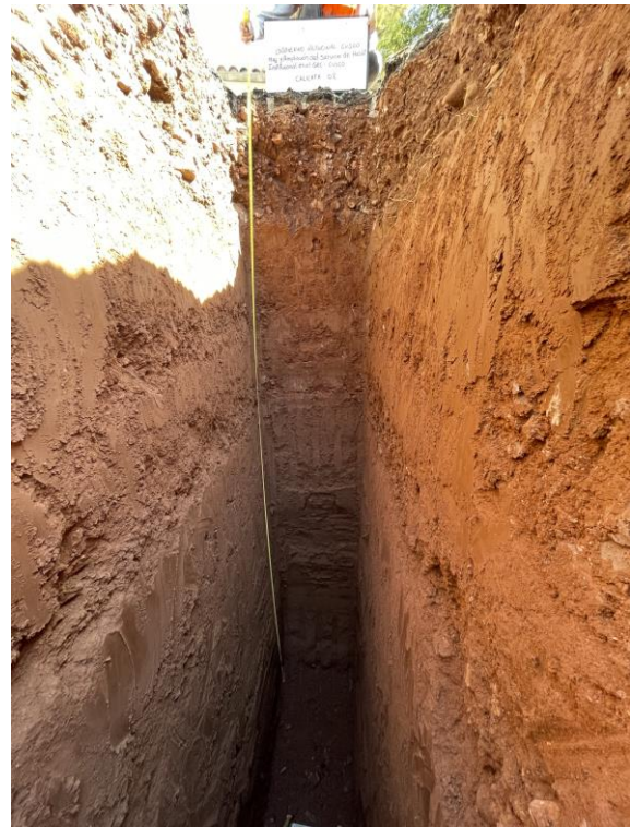
Foto 6: Perfil Estratigráfico Calicata C-02.
