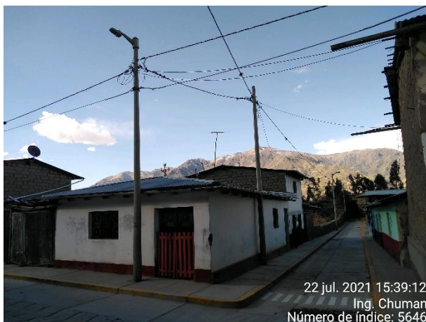
Incumplimiento de DMS en redes secundarias en la localidad de Lampa
