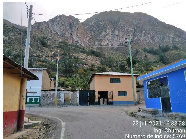
Incumplimiento de DMS de conductores de redes primarias y redes secundarias cerca de fachada de viviendas, en Marcabamba
