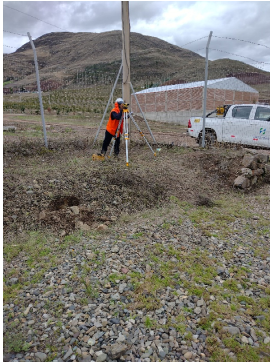
Fig. 3: Estación 1, para la determinación de niveles de las bases y fundaciones del patio de llaves
