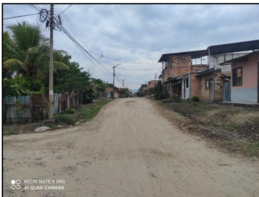
Jr. Bolognesi C 13 – Se aprecia el estado en deterioro en la que se encuentra la vía correspondiente, y también se puede observar la carencia de un drenaje pluvial.
