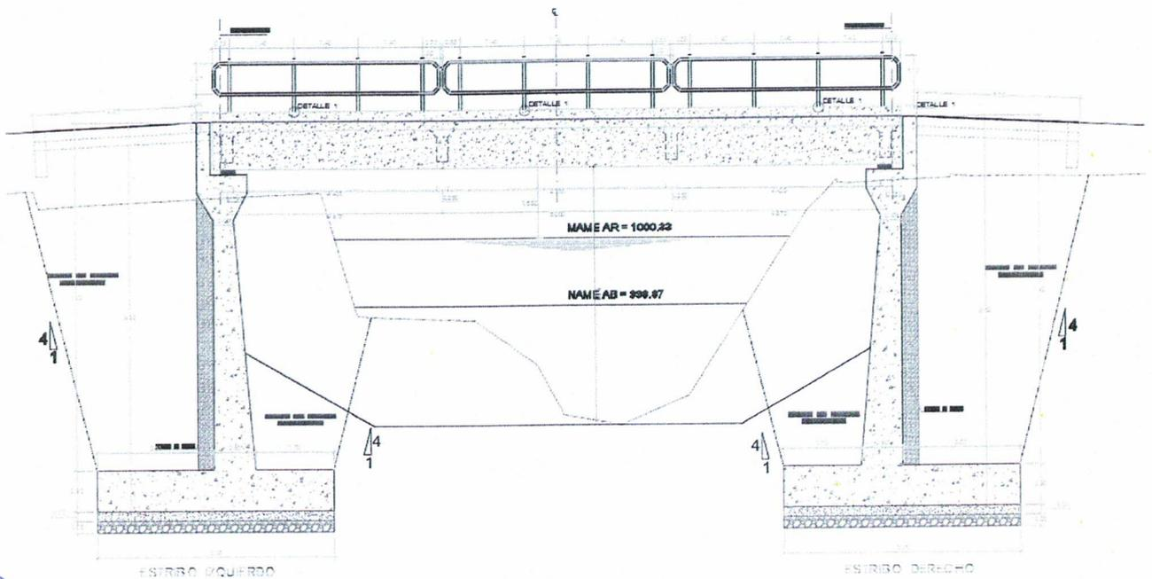
Figura 10: Perfil longitudinal del Puente viga-losa L= 15.00m.
