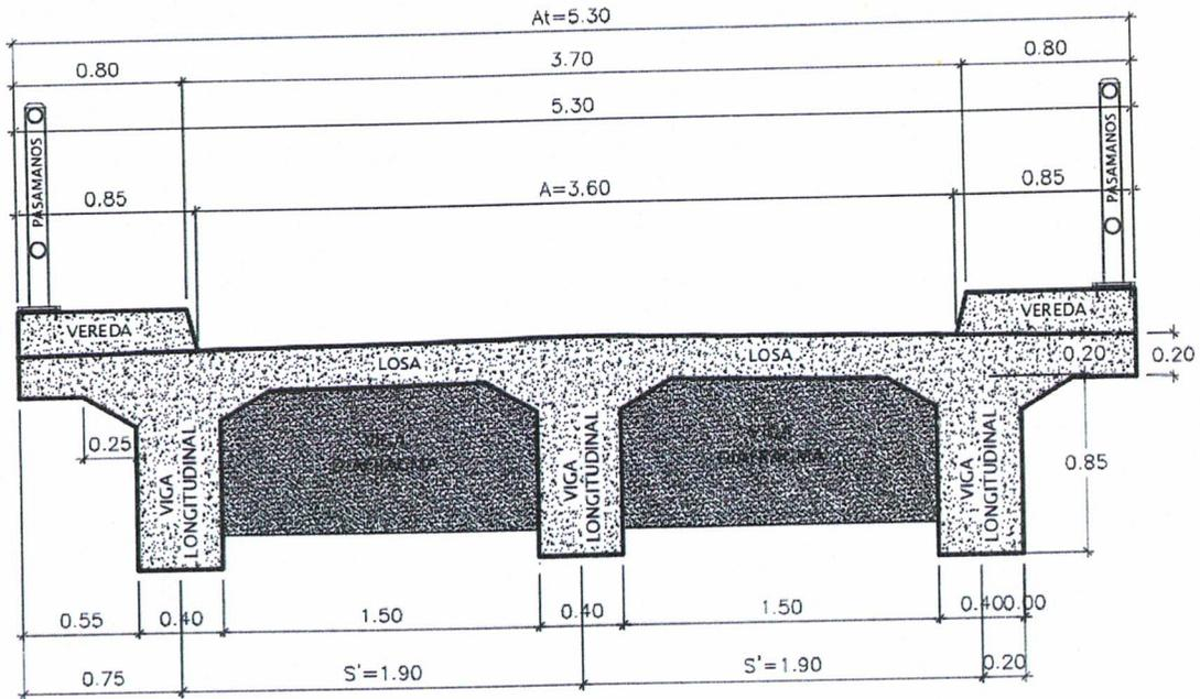
Figura 11: Sección del tablero Puentes viga-losa
