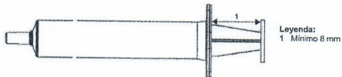
Figura referencial N° 3: Longitud mínima entre las alas de sujeción del cilindro y el disco de empuje del émbolo
