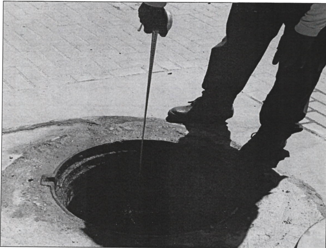
Ilustración 9: Buzones de concreto existentes, toma de profundidades.
