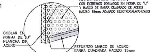
DETALLE B DOBLEZ ESC: 1/5
