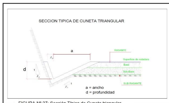
FIGURA N° 27: Sección Típica de Cuneta triangular.
