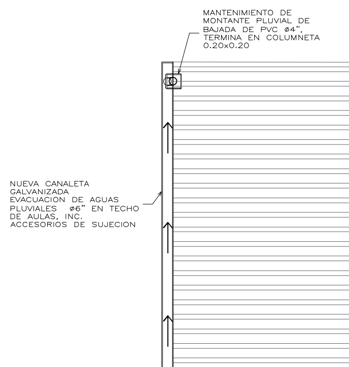
PLANTA INST. CANALETA PLUVIAL - PROPUESTA (PABELLON 1) ESC:1/50
