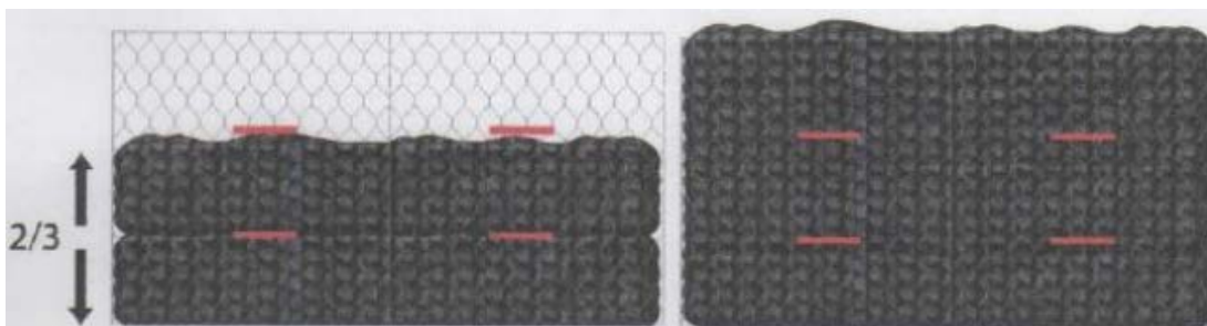
Imagen N° 14 – Posición de los tensores en Gavión.
