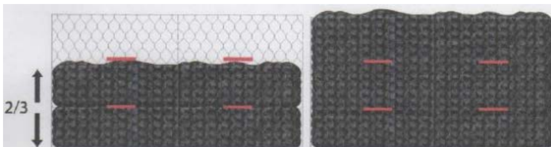
Imagen N° 10 – Posición de los tensores en Gavión.
