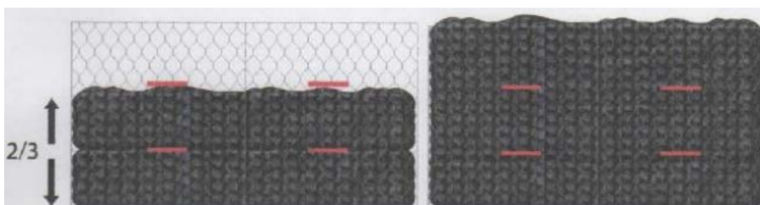
Imagen N° 18 – Posición de los tensores en Gavión.
