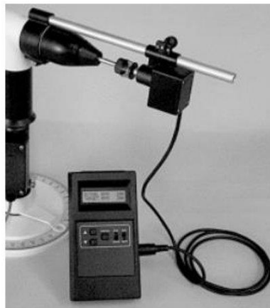
Imagen Referencial N°01: Equipo para verificar velocidad del sensor anemométrico
