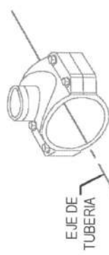
ISOMETRICO ABRAZADERA DOS CUERPOS TERMOPLASTICOS S/E
