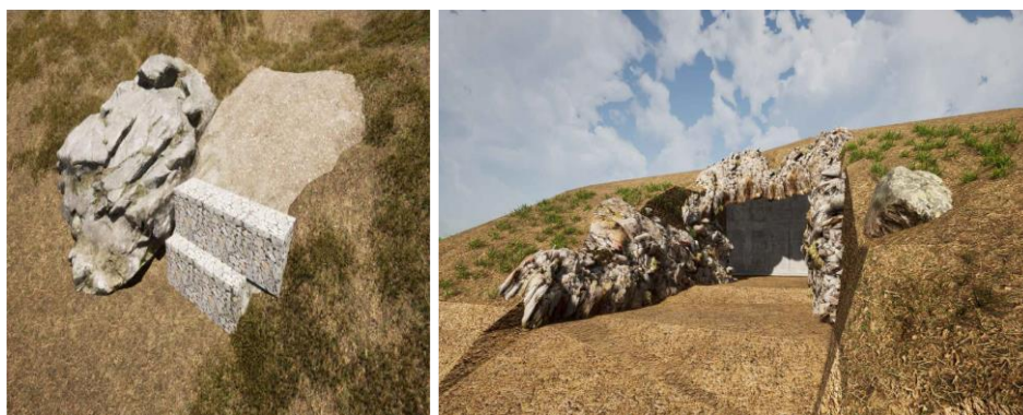
Ilustración 3. Vista 3D del diseño del cierre de la bocamina
