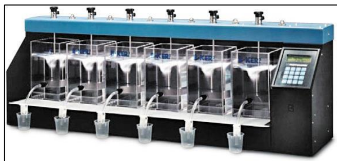
Ilustración 1 Equipo de prueba de jarras de 2L
