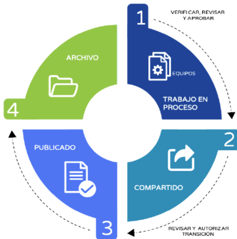
Ilustración 6: Estados de un Contenedor de Información dentro del CDE según la NTP-ISO 19650. Fuente: Guía Nacional BIM
