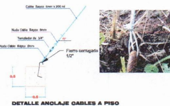
DETALLE ANCLAJE CABLES A PISO
