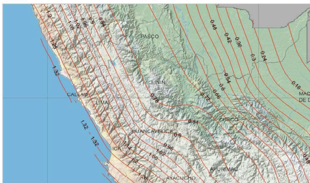
Figura 3: Mapa de isoaceleraciones espectrales suelo tipo B, AASHTO 2014 (Roca). Periodo estructural de 0.2 seg (Ss = 1.26 g).
