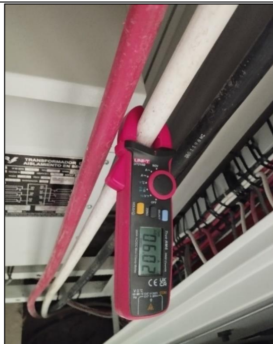
Foto 08: se observa desbalance de cargas
