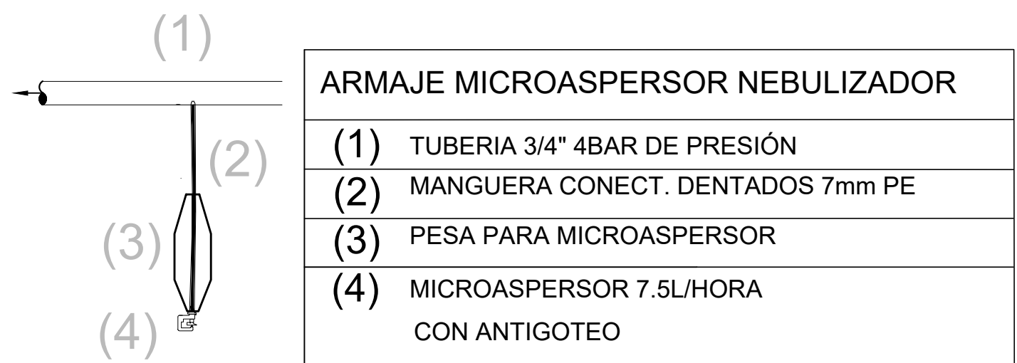
DETALLE DE MICROASPIERSOR NEBULIZADOR ESC. 1/25
