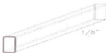
DETALLE ISOMETRICO CORREA ESC. 1/20
