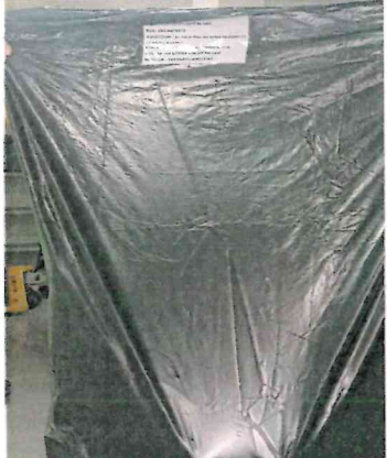
Muestra 1: Bolsa de polietileno de baja densidad de 100 litros – color negro, no se ha roto, no se ha desgarrado, no se abrió durante su manipulación y traslado.
