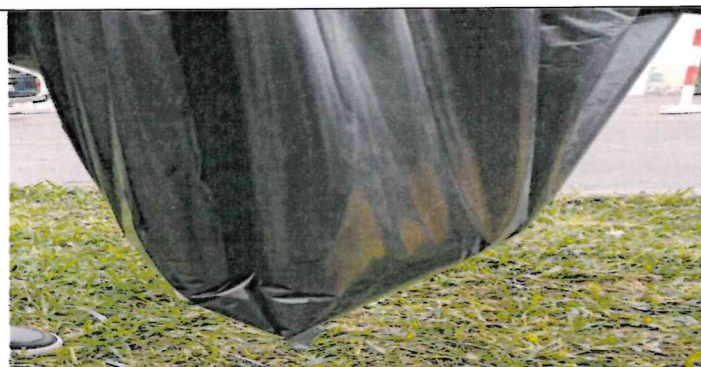
Muestra 2: Bolsa de polietileno de baja densidad de 260 litros – color negro, no presenta fugas de agua.
