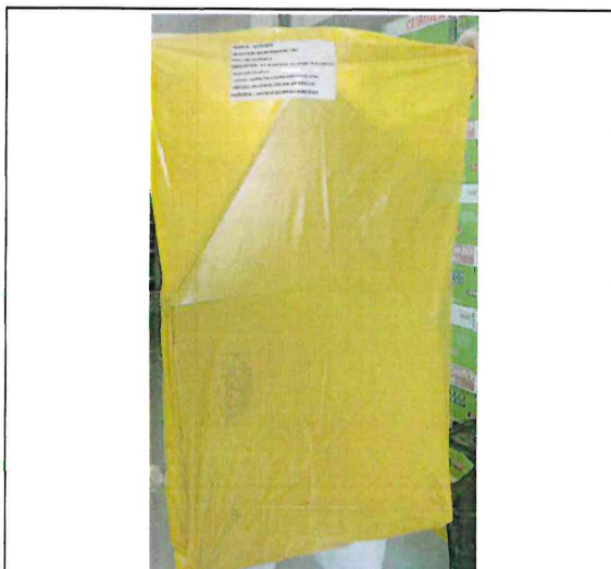
Muestra 1: Bolsa de polietileno de baja densidad de 30 litros – color amarillo, no se ha roto, no se ha desgarrado, no se abrió durante su manipulación y traslado.
