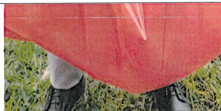
Muestra 2: Bolsa de polietileno de baja densidad de 260 litros – color rojo, no presenta fugas de agua.
