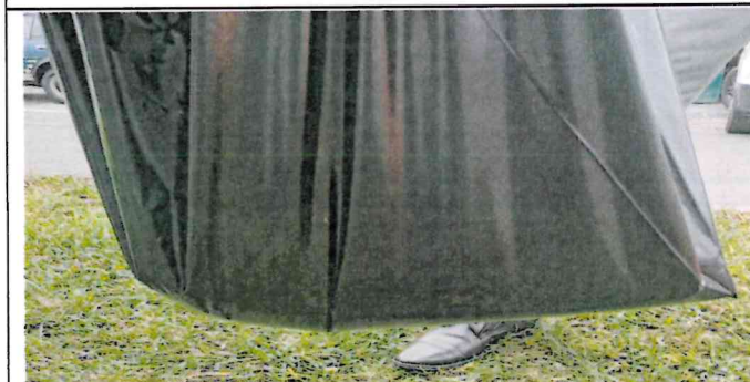
Muestra 1: Bolsa de polietileno de baja densidad de 100 litros – color negro, no presenta fugas de agua.
