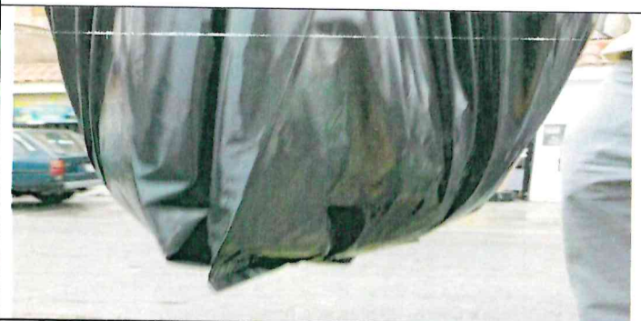
Muestra 2: Bolsa de polietileno de baja densidad de 180 litros – color negro, no presenta fugas de agua.
