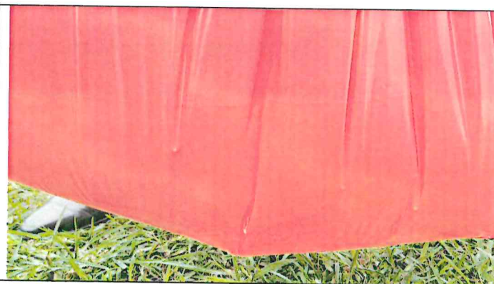
Muestra 2: Bolsa de polietileno de baja densidad de 180 litros – color rojo, no presenta fugas de agua.
