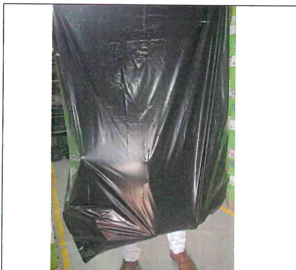
Muestra 1: Bolsa de polietileno de baja densidad de 260 litros – color negro, no se ha roto, no se ha desgarrado, no se abrió durante su manipulación y traslado.
