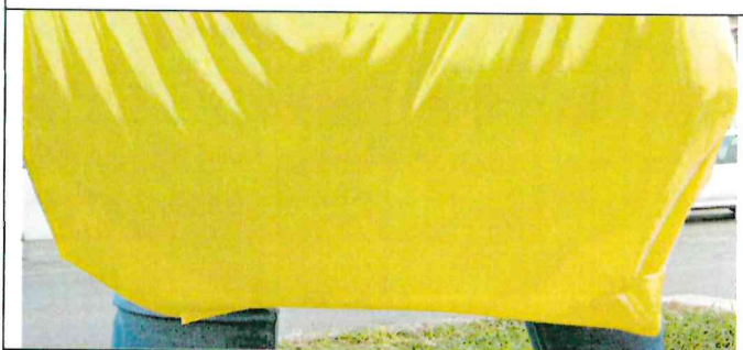
Muestra 2: Bolsa de polietileno de baja densidad de 30 litros – color amarillo, no presenta fugas de agua.
