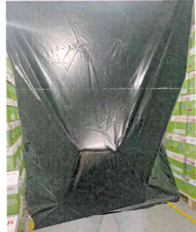
Muestra 2: Bolsa de polietileno de baja densidad de 100 litros – color negro, no se ha roto, no se ha desgarrado, no se abrió durante su manipulación y traslado.
