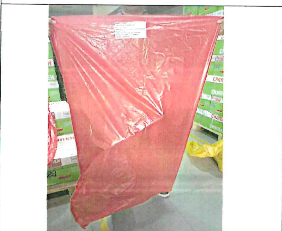
Muestra 2: Bolsa de polietileno de baja densidad de 180 litros – color rojo, no se ha roto, no se ha desgarrado, no se abrió durante su manipulación y traslado.
