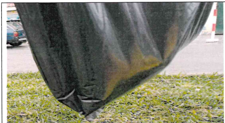
Muestra 1: Bolsa de polietileno de baja densidad de 260 litros – color negro, no presenta fugas de agua.
