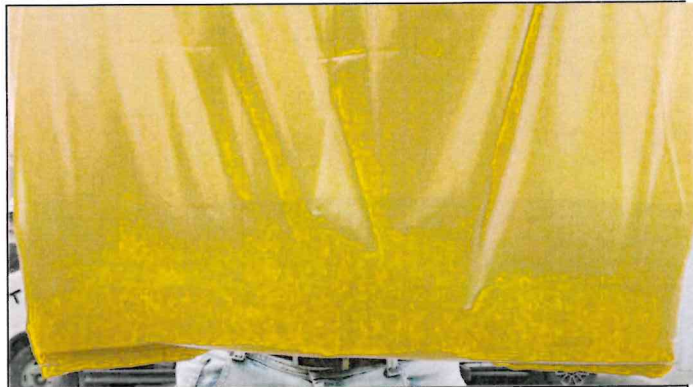
Muestra 1: Bolsa de polietileno de baja densidad de 60 litros – color amarillo, no presenta fugas de agua.
