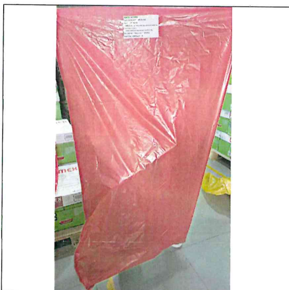
Muestra 1: Bolsa de polietileno de baja densidad de 180 litros – color rojo, no se ha roto, no se ha desgarrado, no se abrió durante su manipulación y traslado.
