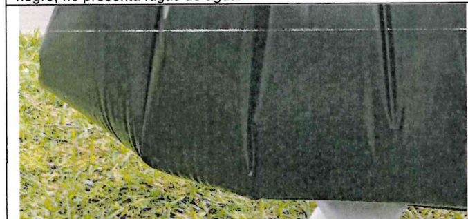
Muestra 2: Bolsa de polietileno de baja densidad de 30 litros – color negro, no presenta fugas de agua.
