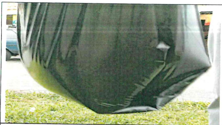
Muestra 1: Bolsa de polietileno de baja densidad de 180 litros – color negro, no presenta fugas de agua.
