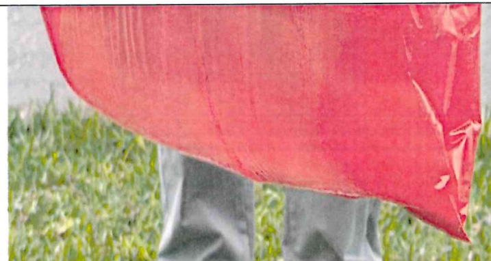
Muestra 1: Bolsa de polietileno de baja densidad de 260 litros – color rojo, no presenta fugas de agua.
