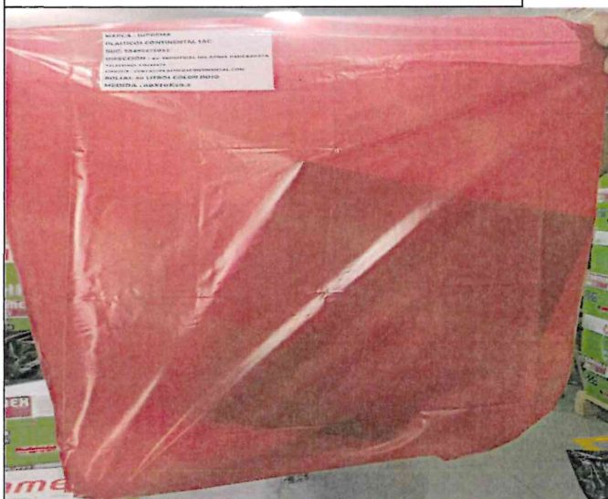
Muestra 1: Bolsa de polietileno de baja densidad de 30 litros – color rojo, no se ha roto, no se ha desgarrado, no se abrió durante su manipulación y traslado.
