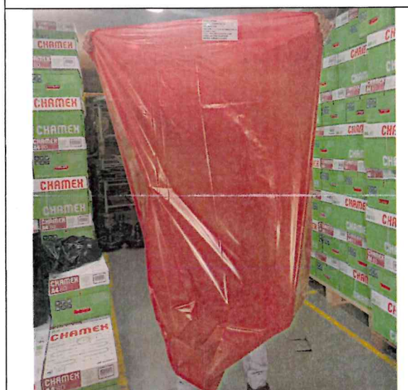
Muestra 2: Bolsa de polietileno de baja densidad de 260 litros – color rojo, no se ha roto, no se ha desgarrado, no se abrió durante su manipulación y traslado.
