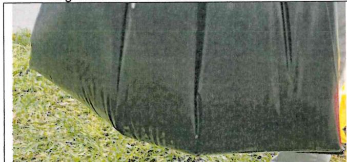
Muestra 1: Bolsa de polietileno de baja densidad de 30 litros – color negro, no presenta fugas de agua.
