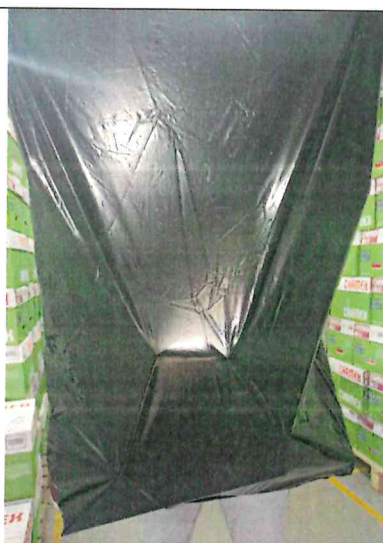
Muestra 2: Bolsa de polietileno de baja densidad de 260 litros – color negro, no se ha roto, no se ha desgarrado, no se abrió durante su manipulación y traslado.
