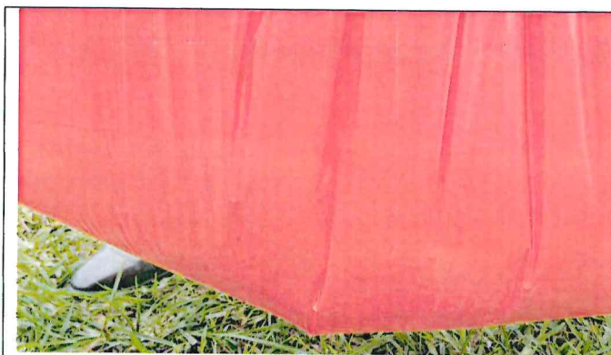
Muestra 1: Bolsa de polietileno de baja densidad de 30 litros – color rojo, no presenta fugas de agua.
