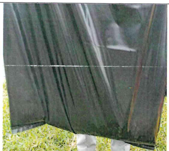
Muestra 1: Bolsa de polietileno de baja densidad de 180 litros – color negro, no se ha roto, no se ha desgarrado, no se abrió durante su manipulación y traslado.
