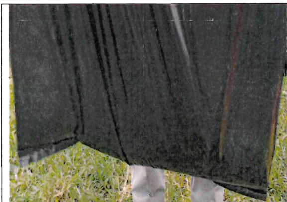
Muestra 2: Bolsa de polietileno de baja densidad de 180 litros – color negro, no se ha roto, no se ha desgarrado, no se abrió durante su manipulación y traslado.
