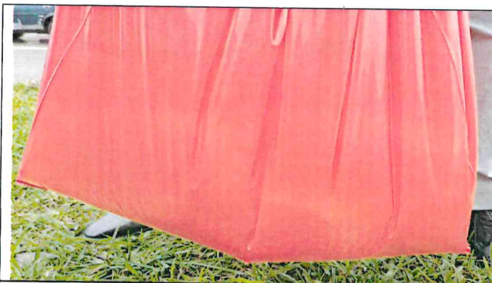
Muestra 1: Bolsa de polietileno de baja densidad de 180 litros – color rojo, no presenta fugas de agua.
