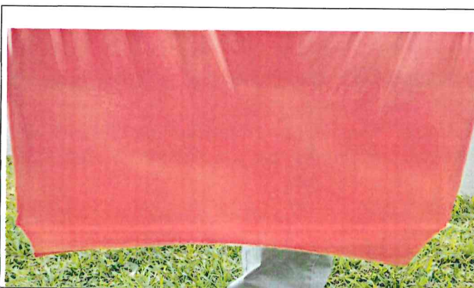
Muestra 2: Bolsa de polietileno de baja densidad de 30 litros – color rojo, no presenta fugas de agua.
