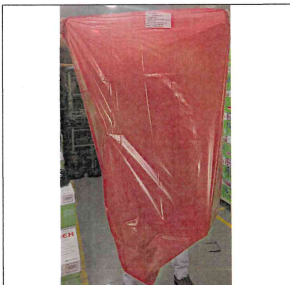
Muestra 1: Bolsa de polietileno de baja densidad de 260 litros – color rojo, no se ha roto, no se ha desgarrado, no se abrió durante su manipulación y traslado.
