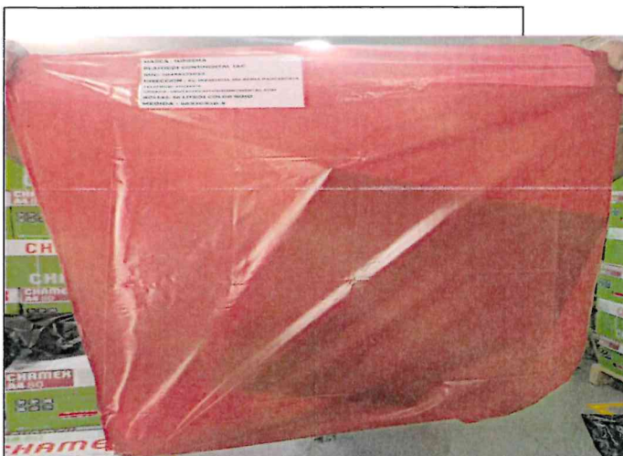
Muestra 2: Bolsa de polietileno de baja densidad de 30 litros – color rojo, no se ha roto, no se ha desgarrado, no se abrió durante su manipulación y traslado.
