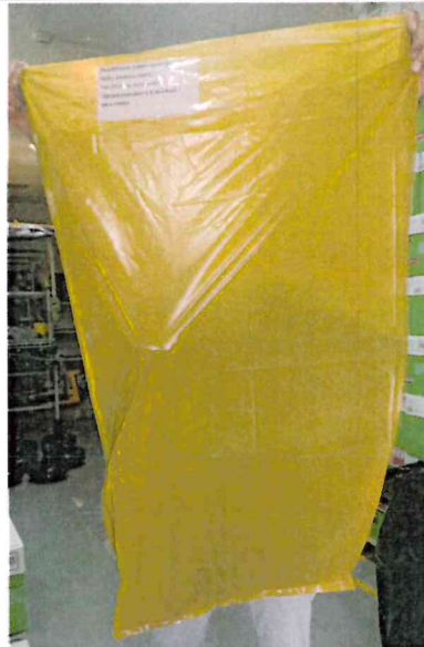
Muestra 2: Bolsa de polietileno de baja densidad de 60 litros – color amarillo, no se ha roto, no se ha desgarrado, no se abrió durante su manipulación y traslado.
