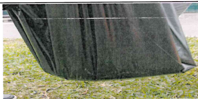
Muestra 2: Bolsa de polietileno de baja densidad de 100 litros – color negro, no presenta fugas de agua.
