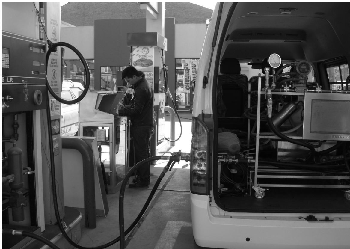
Fotografía N°1. Montaje del Equipo en la parte posterior del vehículo
