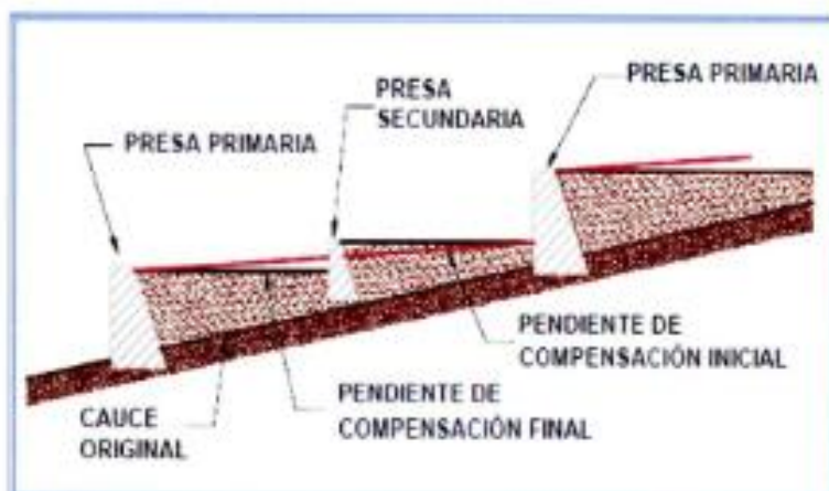
Figura 3.- Modificación de la pendiente de compensación por efecto de colocación de una presa secundaria. (Imagen tomada de Suarez V., I.M. 1993).
