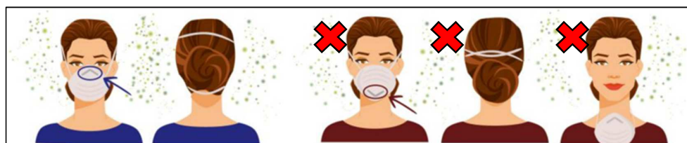
Figura 10. Uso correcto e incorrecto del protector respiratorio (máscara filtrante tipo N95)
