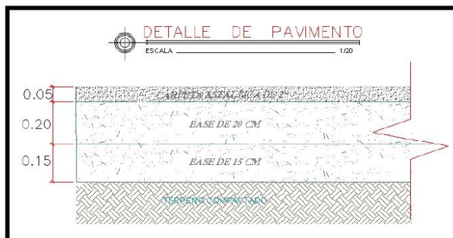
Ilustración 3: Detalle de la estructura del pavimento
