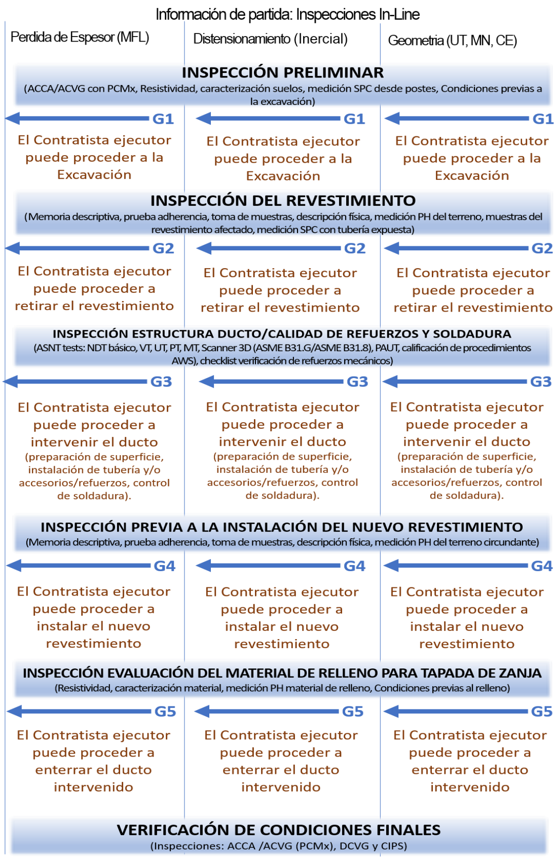
Figura N°2: Etapas de la intervención en el ducto.
