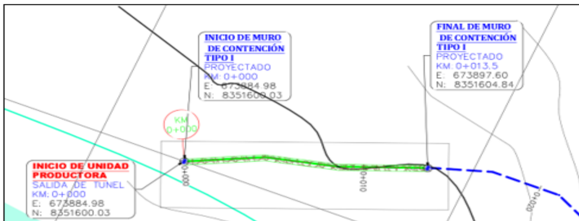
Imagen 1: Tramo de muro de contención Tipo I.
