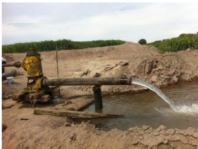
Foto N° 10,, Pruebas de Bombeo del Pozo
