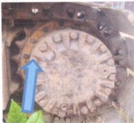
Foto N°07 Perno de Sprocket.
