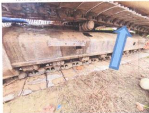
Foto N°05 Carriles Superiores en mal estado.
