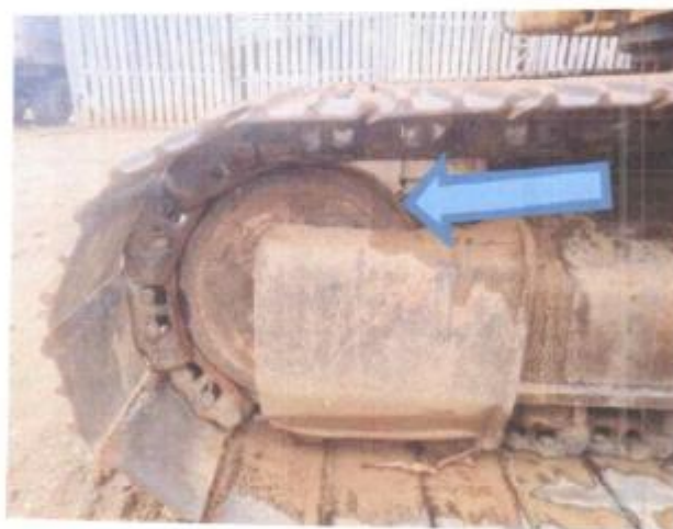
Foto N°03 Rueda guía en mal estado.
