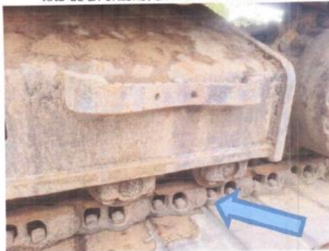
Foto N°04 Carriles Inferiores en mal estado.
