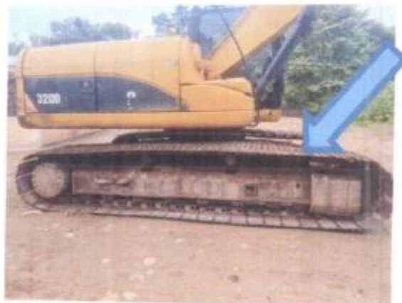
Foto N°01 Se puede apreciar el mal estado de la cadena.
