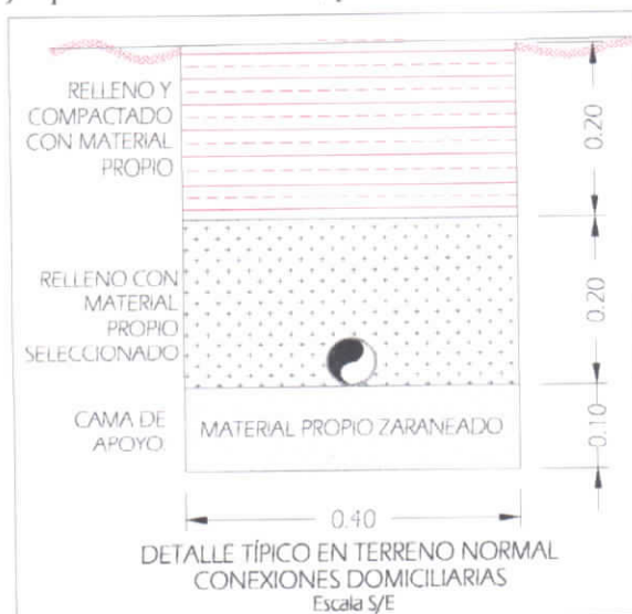
Gráfico 49. Detalle de zanja típica en terreno normal, para conexiones domiciliarias – Sistema 03.
