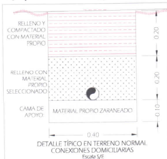
Gráfico 85. Detalle de zanja típica en terreno normal, para conexiones domiciliarias – Sistema 05.
