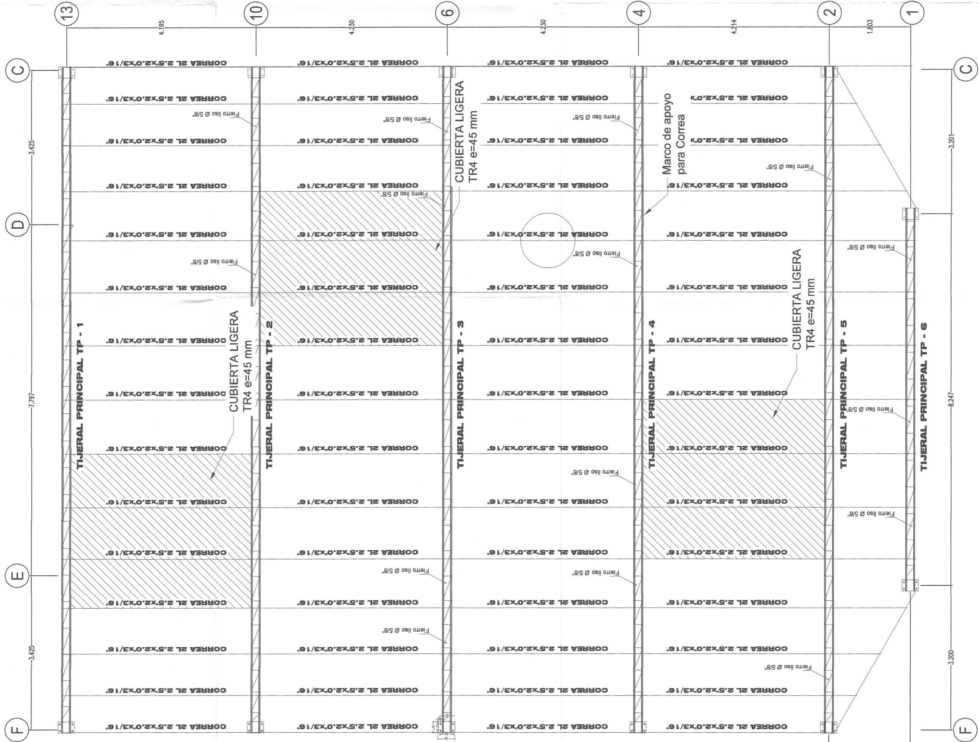
ESTRUCTURA METALICA - SALON DE USOS MULTIPLES Esc: 1/75
