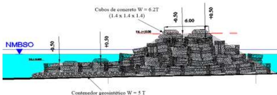
Figura 6: Sección transversal tipo de rompeolas emergidos para el balneario de Buenos Aires.
