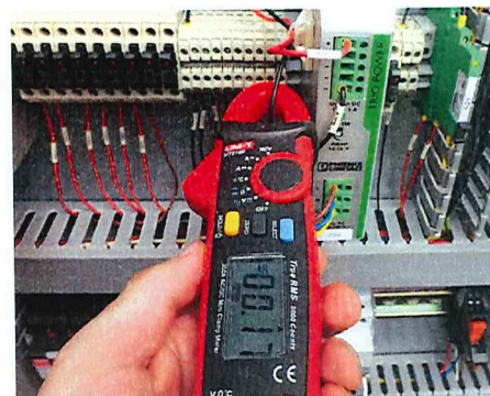
Foto N°6: Consumo salida de fuente de alimentación 12VDC. 170 mAac
