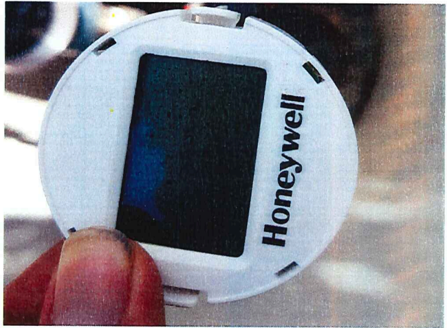
Foto N°5: Display con humedad en transmisor Hart. Vista interna.
