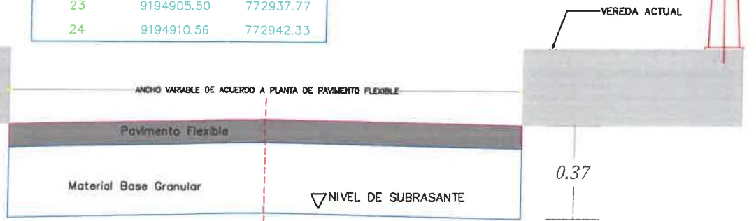
SECCION TRANSVERSAL DE PAVIMENTO FLEXIBLE
