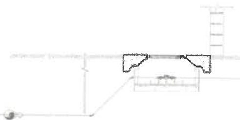
Imagen 153. Corte de losa, caja de agua termoplástica y conexión domiciliar medida desde la red de distribución del sector Santa Rosa del caserio Cajas Shapaya.
