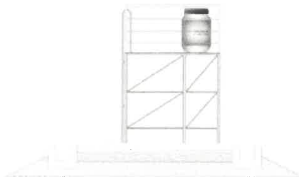
Imagen 33. Caseta metálica y sistema de protección del tanque dosador del sistema N° 01 del sector Cumbata del caserio de Cajas Shapaya.
