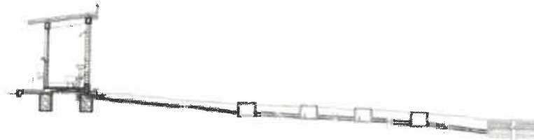
Imagen 167. Corte de distribución de caseta UBS con arrastre hidráulico y zanjas de percolación en sistema multifamiliar del sector Santa Rosa del caserío Cajas Shapaya.
