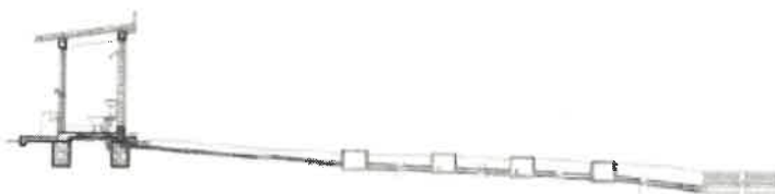
Imagen 106. Corte de distribución de caseta UBS con arrastre hidráulico y zanjas de percolación en sistema multifamiliar del sistema N° 02 del sector Cumbata del caserio de Cajas Shapaya.
