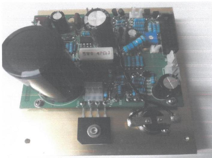
**b) MODULO AMPLIFICADOR DE POTENCIA PARA TRANSMISOR DE FM 50W**
