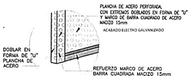
DETALLE B DOBLEZ ESC: 1/5
