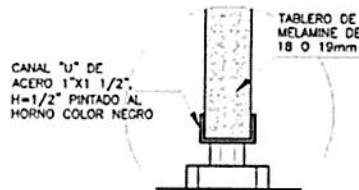
DETALLE C REGATÓN ESC: 1/2
