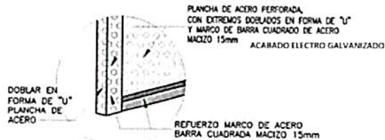
DETALLE B DOBLEZ ESC: 1/5
