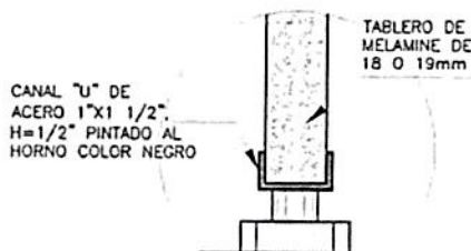
DETALLE C REGATÓN ESC: 1/2
