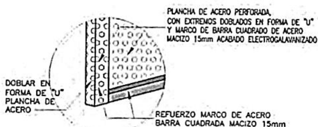
DETALLE B DOBLEZ ESC: 1/5
