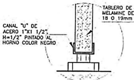
DETALLE C REGATÓN ESC: 1/2
