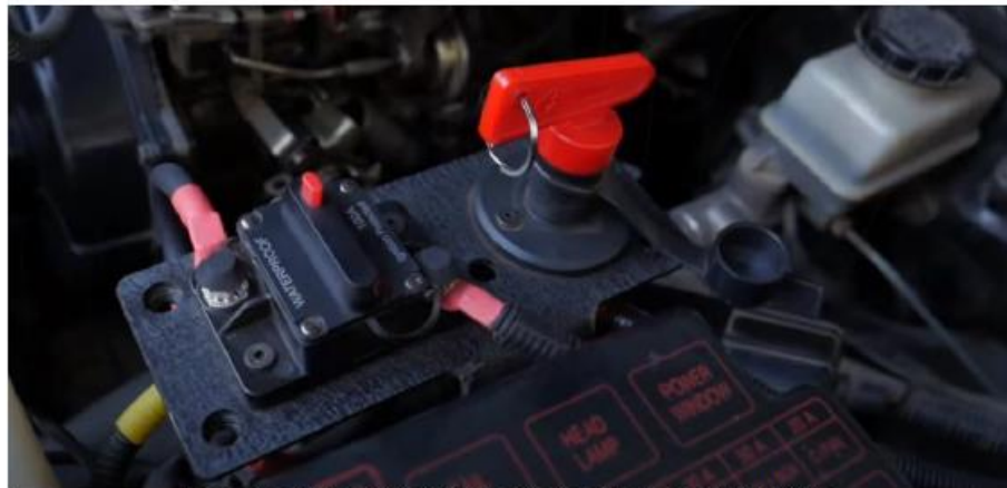
Imagen referencial de instalación de breaker en un vehículo
