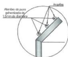
DETALLE DE ALAMBRADO ESTRUCTURA ESCALA: 5/8
