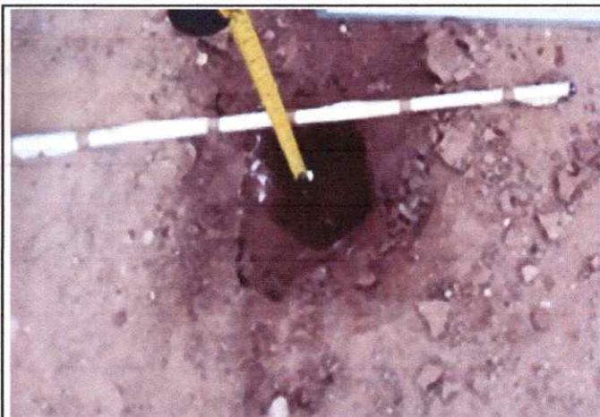
Foto 38: Espesor de la plataforma 0.05 mts. EJE En el Km. 9+250
