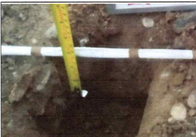
Foto 03: Espesor de la plataforma 0.05 mts. En el Km. 0+500
