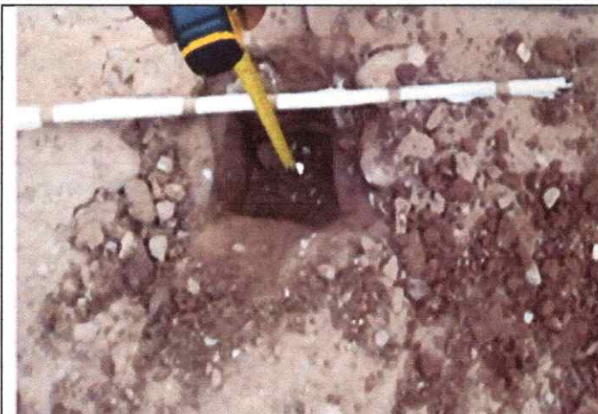
Foto 37: Espesor de la plataforma 0.05 mts. EJE En el Km. 9+000
