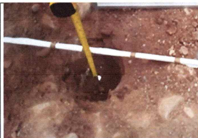
Foto 41: Espesor de la plataforma 0.05 mts. EJE En el Km. 10+000
