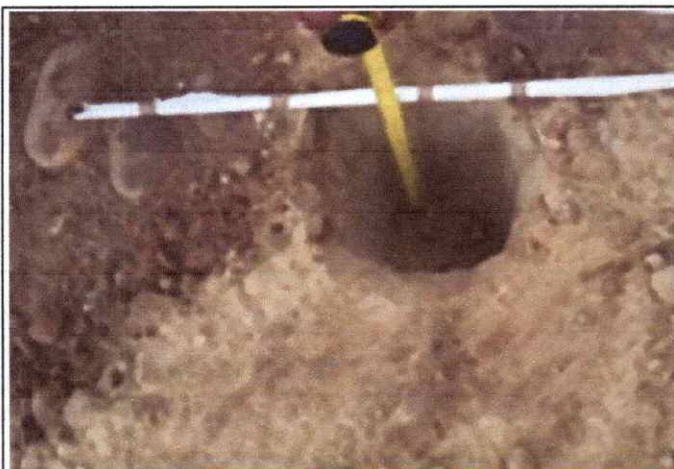
Foto 17: Espesor de la plataforma 0.05 mts. En el Km. 4+000
