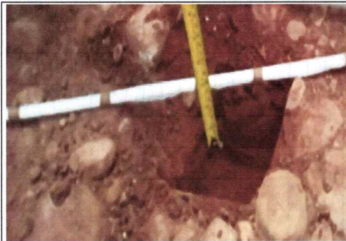
Foto 43: Espesor de la plataforma 0.04 mts. LD En el Km. 10+500
