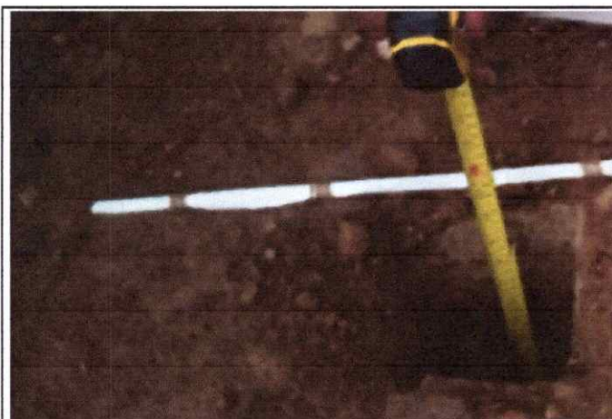
Foto 15: Espesor de la plataforma 0.05 mts. En el Km. 3+500
