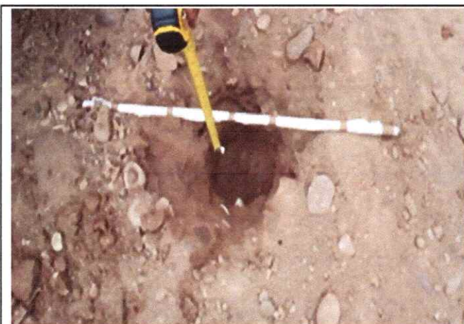
Foto 39: Espesor de la plataforma 0.05 mts. LI En el Km. 9+500
