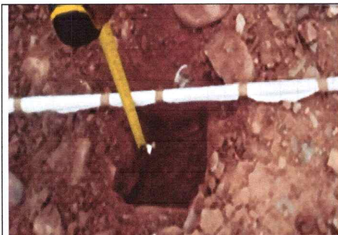
Foto 47: Espesor de la plataforma 0.04 mts. LD En el Km. 11+500
