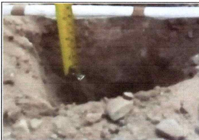
Foto 02: Espesor de la plataforma 0.05 mts. En el Km. 0+250
