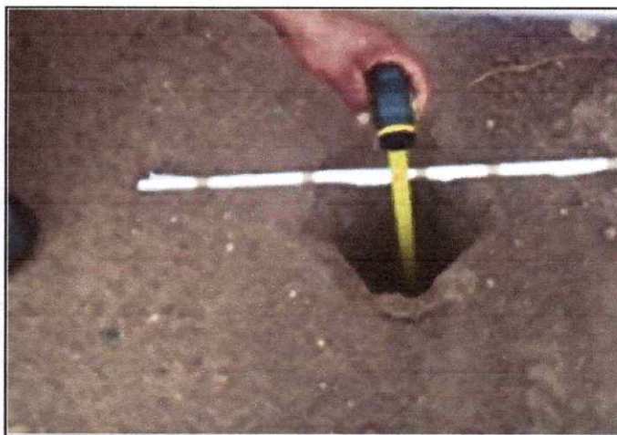
Foto 14: Espesor de la plataforma 0.04 mts. En el Km. 3+250
