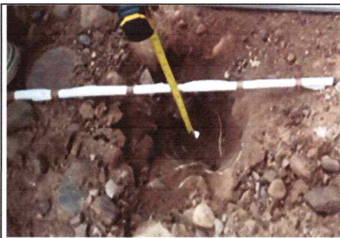
Foto 40: Espesor de la plataforma 0.04 mts. LD En el Km. 9+750
