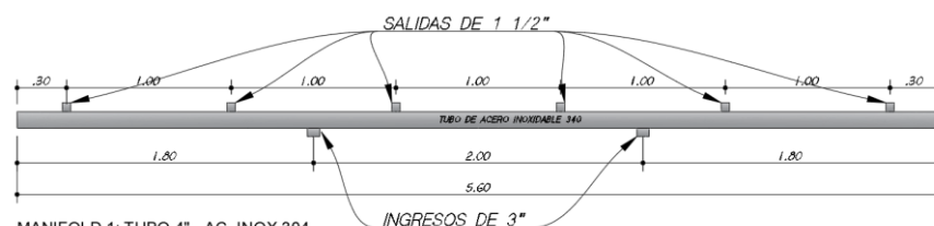
MANIFOLD 1: TUBO 4" - AC -INOX 304 LONG= 5.60m 6 SALIDAS DE 1 1/2" 2 INGRESOS DE 3"
