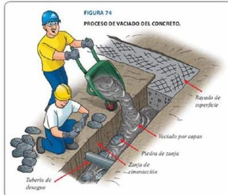
Sólo podrá emplearse agua potable o agua limpia de buena calidad, libre de impurezas que pueda dañar el concreto; se humedecerá las zanjas antes de llenar los cimientos y no se colocarán las piedras sin antes haber depositado una capa de concreto de por lo menos 10 cms. de espesor. Las piedras deberán quedar completamente rodeadas por la mezcla sin que se tome los extremos.
