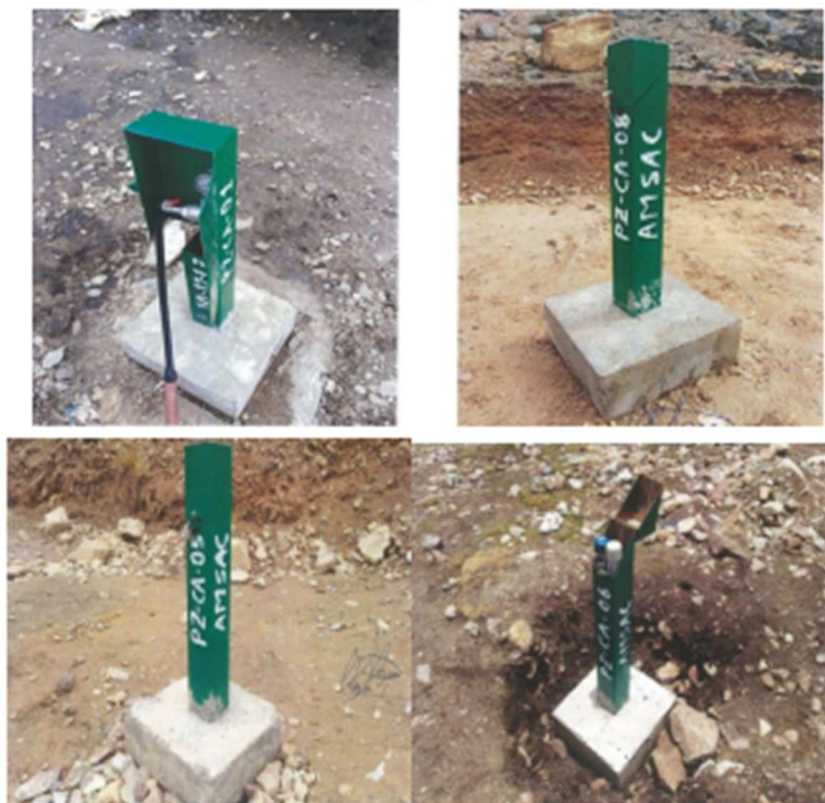
Figura 5: Modelo de piezómetro instalados
