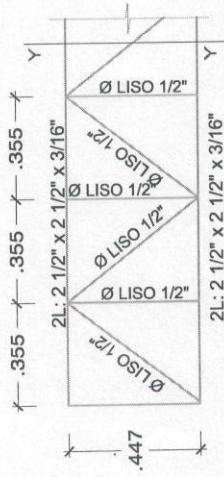
PLANTA INFERIOR VIGA VM-1 ESCALA: 1 / 25
