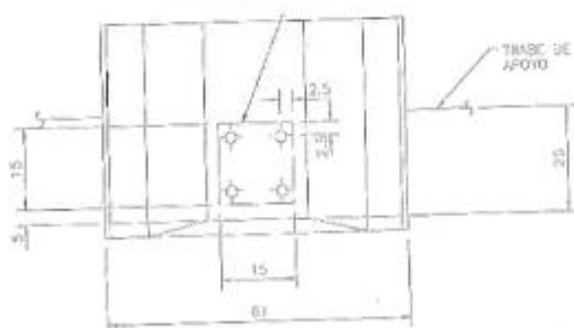
Imagen 5. Vista en planta de anclaje en viga de apoyo.
