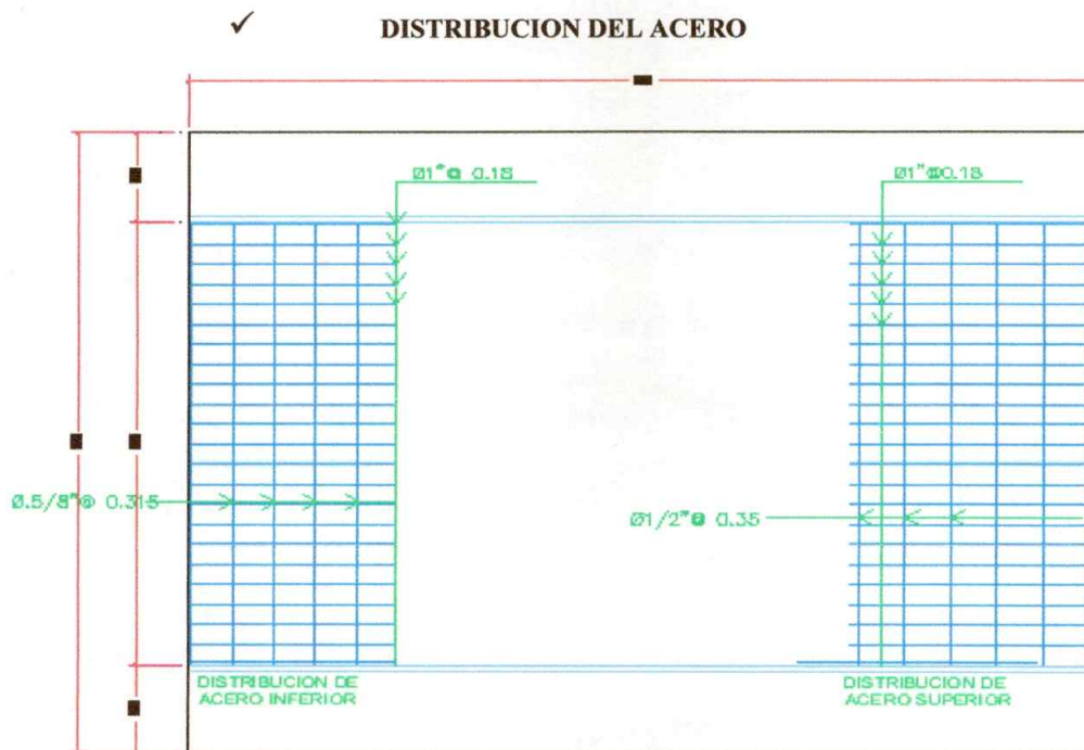
Distribución del acero en Losa
