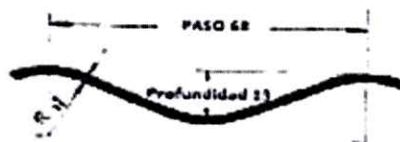
Figura 1. Dimensiones de la corruaga 68 mm x 13 mm
