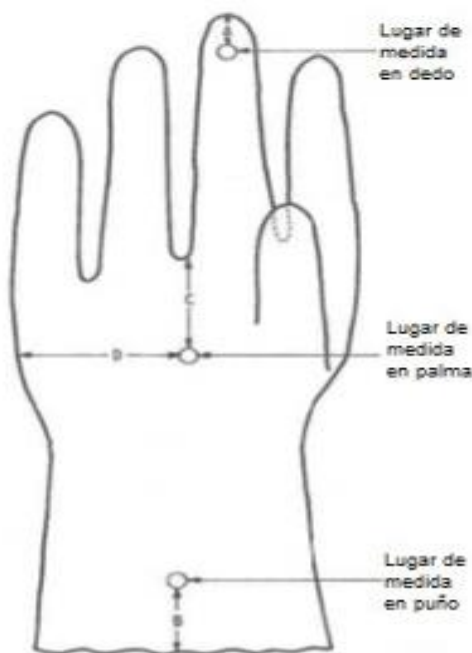
FIGURA N° 2: Puntos de medición para espesor
