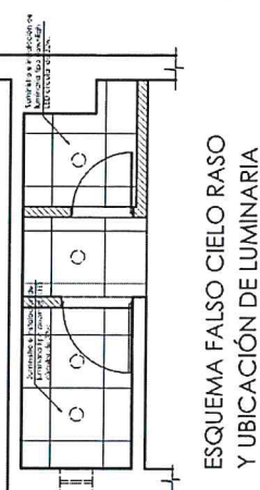
ESQUEMA FALSO CIELO RASO Y UBICACIÓN DE LUMINARIA SS.HH. JUSTICIA TV 1ER PISO ESC: 1:50
